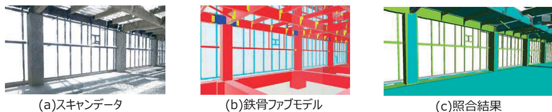
図4 ConstructMonitor による照合結果の例
