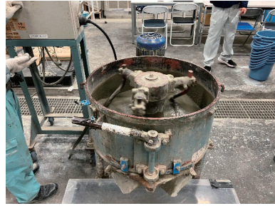
写真3 フレッシュコンクリート練混ぜ状況
