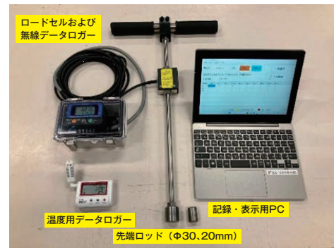
写真2 本試験機の構成
