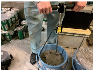
写真7 貫入抵抗値計測状況
