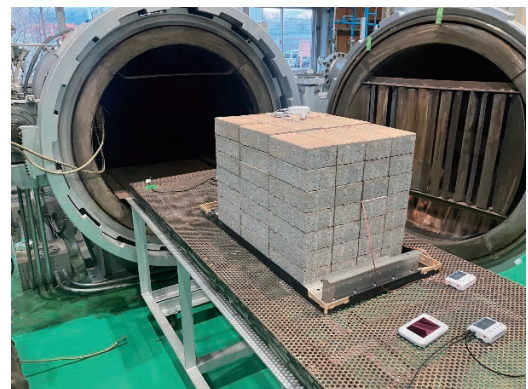
写真2 大型養生槽を用いた検討状況
