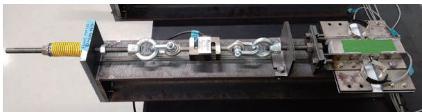
写真2 長期載荷試験装置
