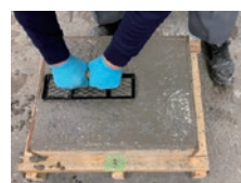
小型試験体による施工試験状況
