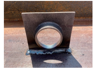
写真1 頭付きスタッド 写真2 バーリングシアコネクタ
