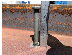
写真1 頭付きスタッド 写真2 バーリングシアコネクタ
