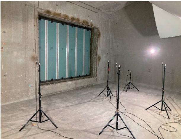
図7 遮音試験状況
