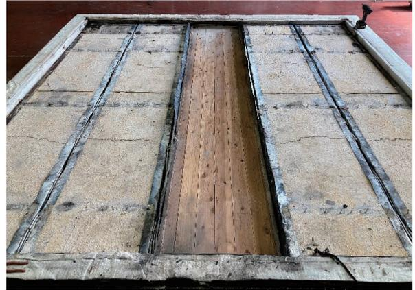
(b) 試験後の状況 (屋外面 (加熱面))
