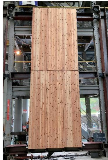
図9 変形追従性能試験状況
