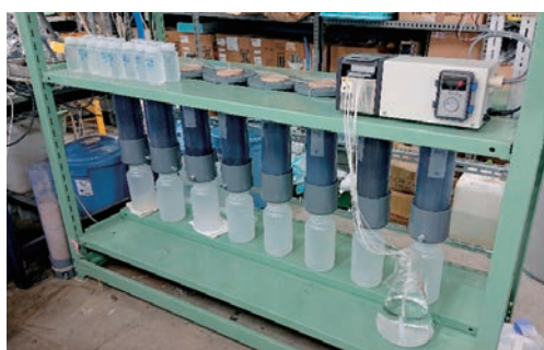
エージングを想定した屋内小型ライシメータ試験 Indoor small lysimeter test simulating aging
