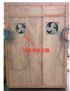
図4 配電盤排気側面
