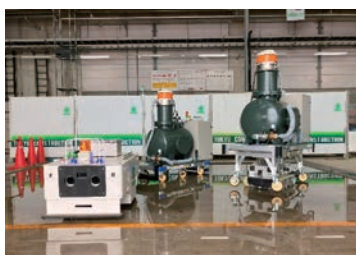
搬送ロボットと水替えアタッチメント
