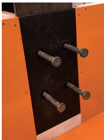
写真1 改質アスファルト系シート防水
