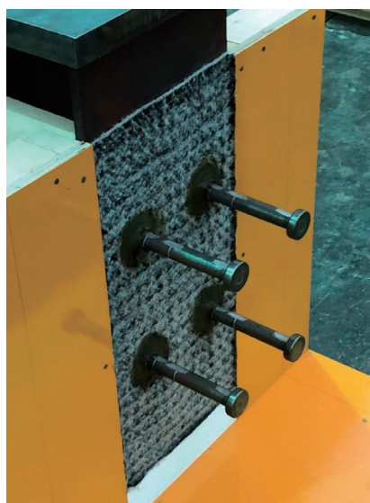
写真2 ベントナイト系シート防水
