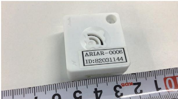
図5 温湿度計 (モノワイヤレス社製)
