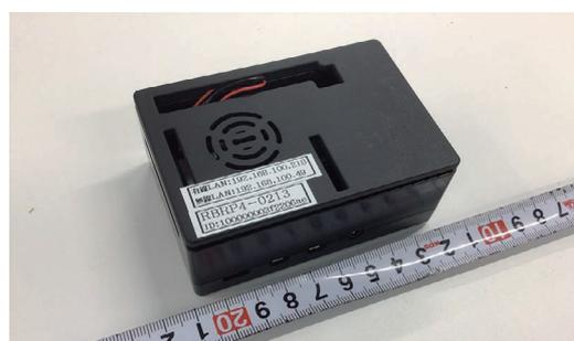
図2 Raspberry Pi (IOT デバイス)
