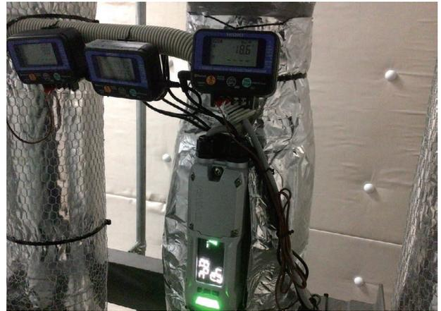
図6 冷温水流量の計測
