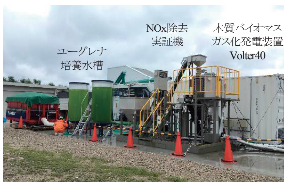
ユーグレナ培養およびNOx除去試験
