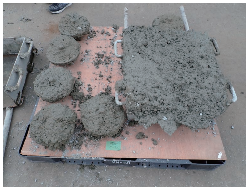
写真3 プルアウト試験および箱吹き状況
