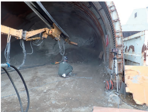
写真1 吹付け実験の状況
