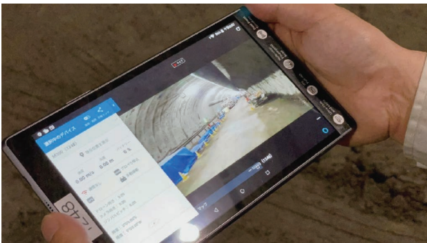
写真3 坑内遠隔確認状況（タブレット端末）
