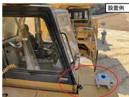
図4 情報送信端末を設置した様子 (installation of information transmission terminal)
