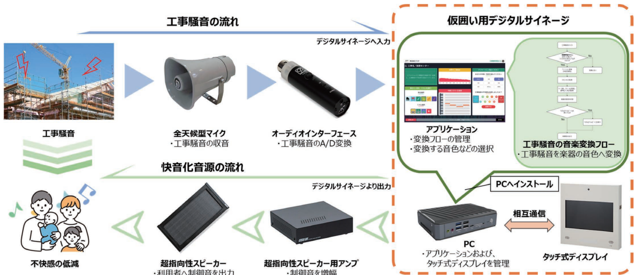
図8 ハードウェアの構成、及び工事騒音の収音から快音化音源出力までの流れ
