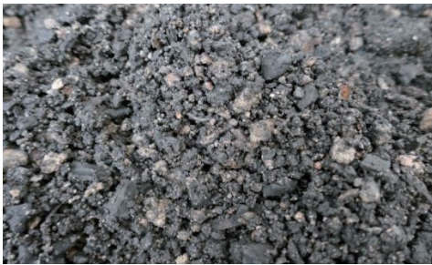
写真3 緑化資材①(浄水発生土:主灰=5:4)
