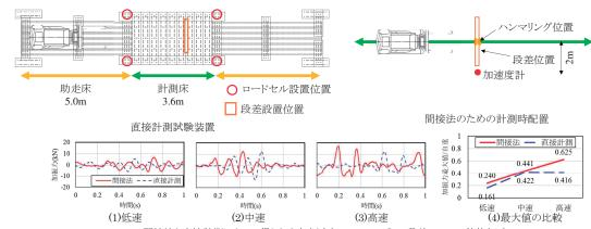
間接法と直接計測によって得られた加振力(1.5tonエンジン, 段差12mm, 積載なし)
