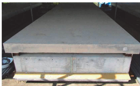
写真2 実大模擬デッキスラブ試験体 (N)
