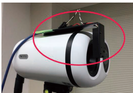
図 11 小型の黒体炉を取り付けた様子(開発中)
