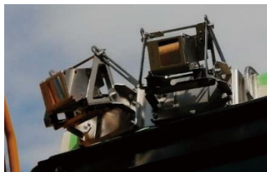
図 7. キャビン上に設置したLiDAR
