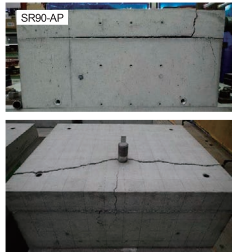
写真3 SR90-APの破壊状況(上:横面、下:上面)
