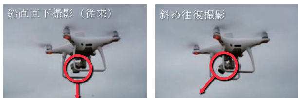
写真2 斜め往復撮影 カメラ角度
