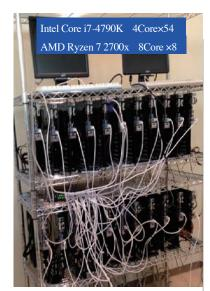
選び出した。その結果、インテルCorei7-4790KとAMD Ryzen 7 2700xの2つのCPUが低エネルギーでは優れた性能であることが分かった。そこで、実際の施設での遮蔽設計を現実的な時間で行うのに必要なCore数を評価したところ、半日で結果を出すためには250Core程度必要なことが分かった。これをもとに、図に示すようにCore i7-4790Kを54個(216 Core)、Ryzen 7 2700xを8個(64 Core)並列につないだ計算機器環境を構築した。
