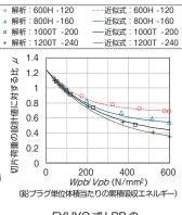
FYUYO式 LRBの 繰返し変形に対する切片荷重の変化
