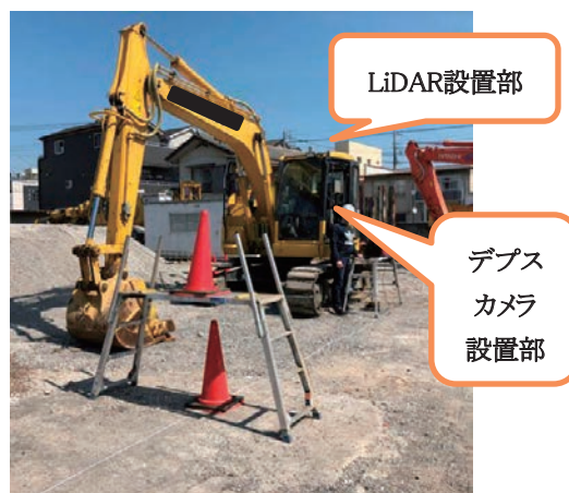
図 4 3次元測域センサによる障害物の計測
