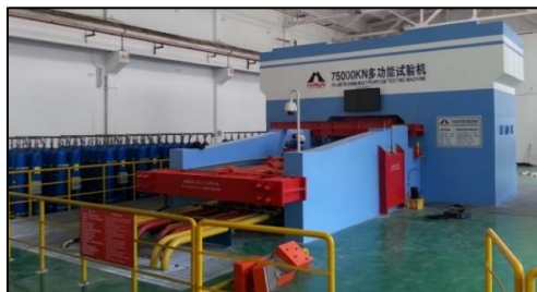
写真 1 大型圧縮せん断試験機
