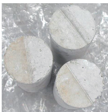
不連続部を有するコンクリート試験体
