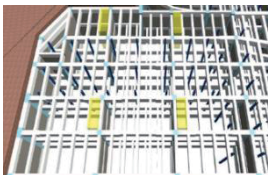
図 21 搬入用床開口部チェック
