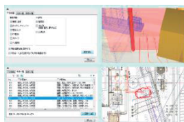
図 22 設備と建築の干渉チェック
