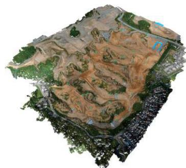
図 4 複数枚の画像から生成した点群の例
