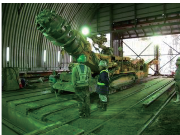
トンネル掘削に用いる掘削機（自由断面掘削機S-100）の外観と切羽での掘削（切削）状況
