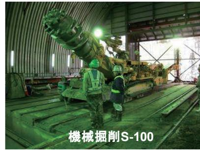
写真3 自由断面掘削機(S-100)の外観
