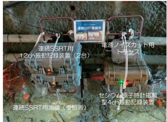
写真2 坑内作業ノイズの観測状況(振動記録装置)
