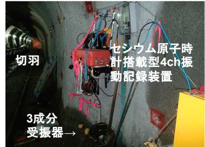
写真5 観測機器の坑内配置
