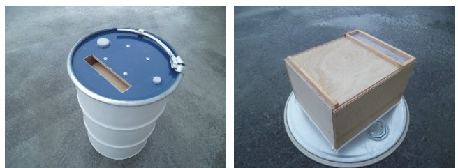
写真2 作成したドラムサイレンサー
