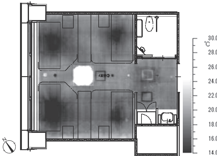
図 5 冷房時の天井表面温度分布
