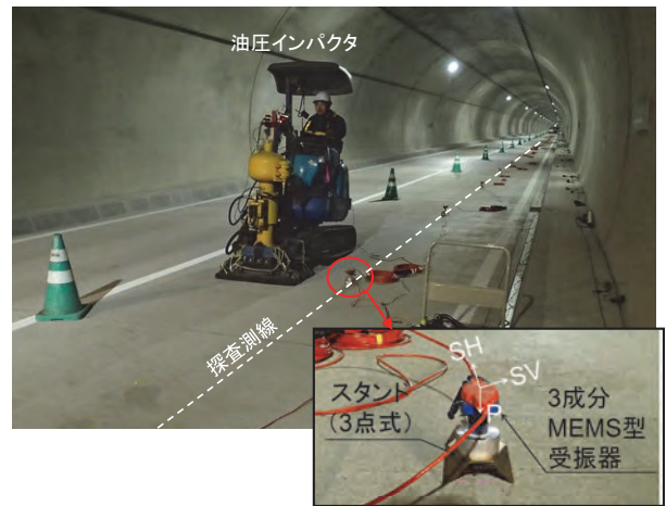
写真 1 新トンネルにおける弾性波速度測定状況
