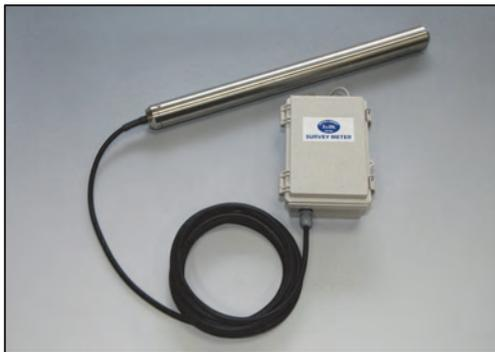
写真2 GM 式水中サーベイメータ
