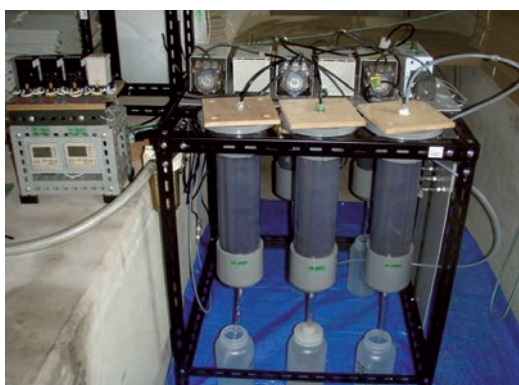
焼却飛灰を充填したカラムによる洗浄試験
