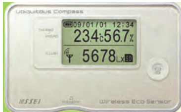
写真 3 市販の ZigBee 通信付温度センサー例
