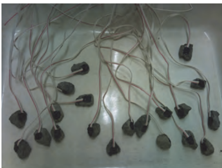
写真 2 粗骨材の乾燥収縮率の測定状況
