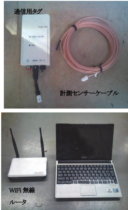
写真1 計測用センサーケーブルおよび周辺機器
