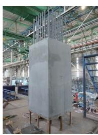
超高強度コンクリートは、若材齢時に大きな自己収縮ひずみが生じ、それが鉄筋により拘束されるとコンクリートに応力が生じる。実大部材ではさらに水和熱に起因する温度応力が加わり、ひび割れ発生の危険性がより高まることが知られている。超高強度コンクリートの実用化のため、当社では過去に低熱セメントを用いた超高強度コンクリートによる実大柱施工実験を実施し、調合や養生条件が収縮やひび割れ発生に及ぼす影響について検討を行っている。今回、新たに中庸熱セメントを用いた超高強度コンクリートについて、圧縮強度や引張強度発現など基礎的物性の把握、また、鉄筋コンクリート柱部材の若材齢時におけるひび割れ発生の危険性の評価を目的とし、実大柱施工実験を行った。その結果、全ての試験体において部材に生じる引張応力が割裂引張強度以下であり、試験体表面及び内部にひび割れが発生しないことを確認した。
