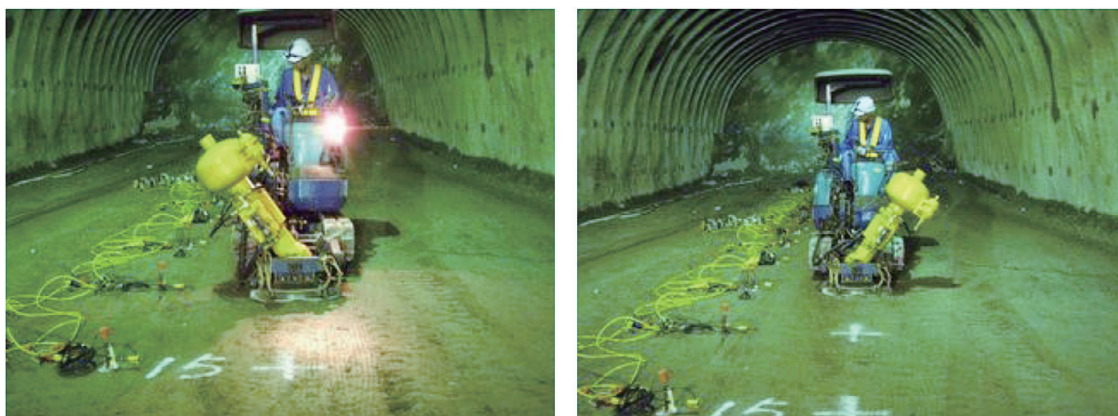
打撃角度が調整可能な油圧インパクトによるS波発震（左右打撃）
