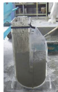
写真 1 U 型充填試験の状況
