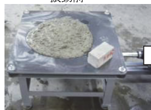
写真 2 加振変形試験の状況
