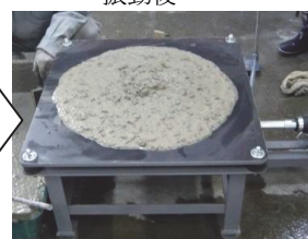
写真 2 加振変形試験の状況
