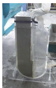
写真 1 U 型充填試験の状況
