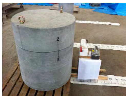
写真6 測定状況(コンクリート内に格納した場合)
