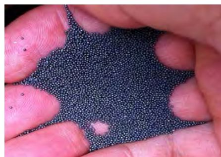
写真 1 骨材として使用した鉄球
