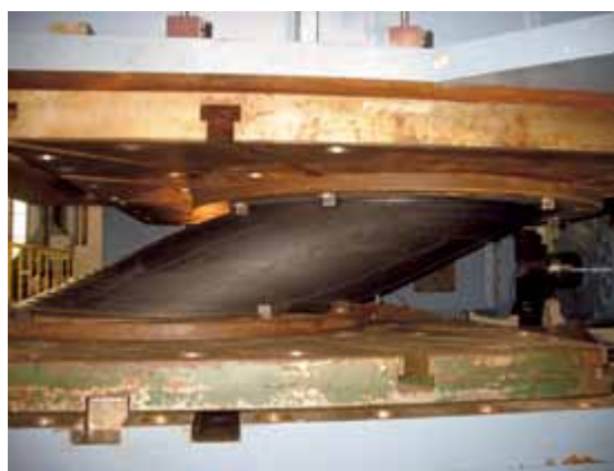
圧縮限界性能確認試験結果 ( \phi 1000 、 \sigma = 1.33 \sigma_0 、 \gamma = 400\% )
