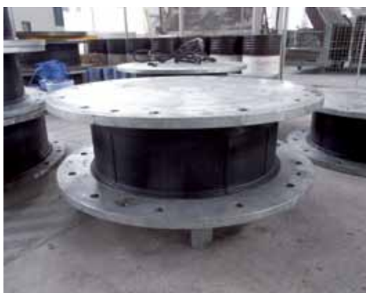
FUYO 式鉛プラグ挿入型積層ゴム支承
