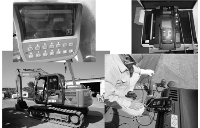
写真5 CO 2 排出量計測状況
