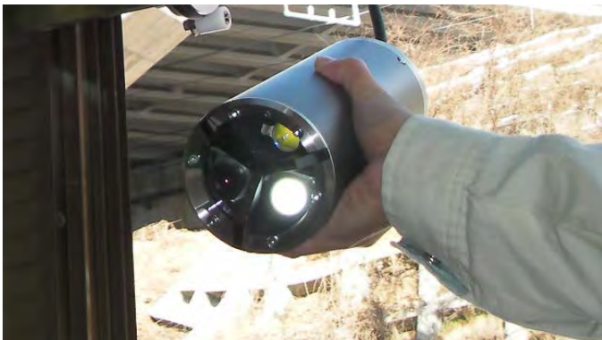
写真 5 改良型カメラユニット(カメラ、距離計一体)
