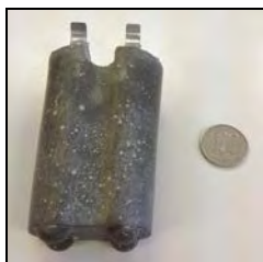
写真 5 IC タグを埋め込んだスペーサー
