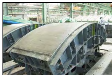
写真 2 コンクリート打設後のセグメント(脱型前)
