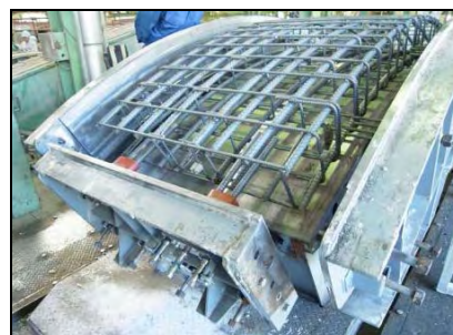
写真 1 コンクリート製セグメントの型枠
