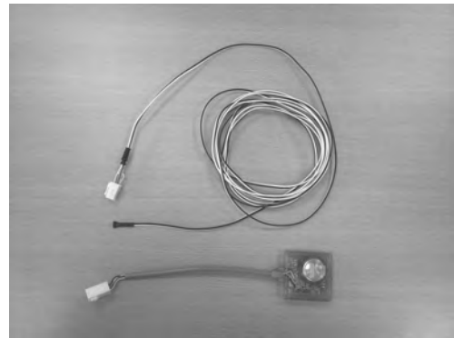
写真4 計測用センサーケーブル
